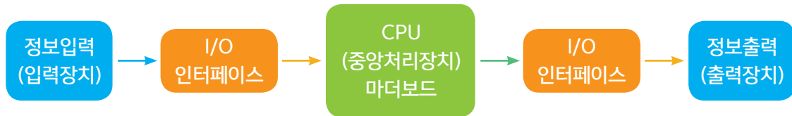
[그림 1-2] 마더보드 Super I/O 인터페이스
